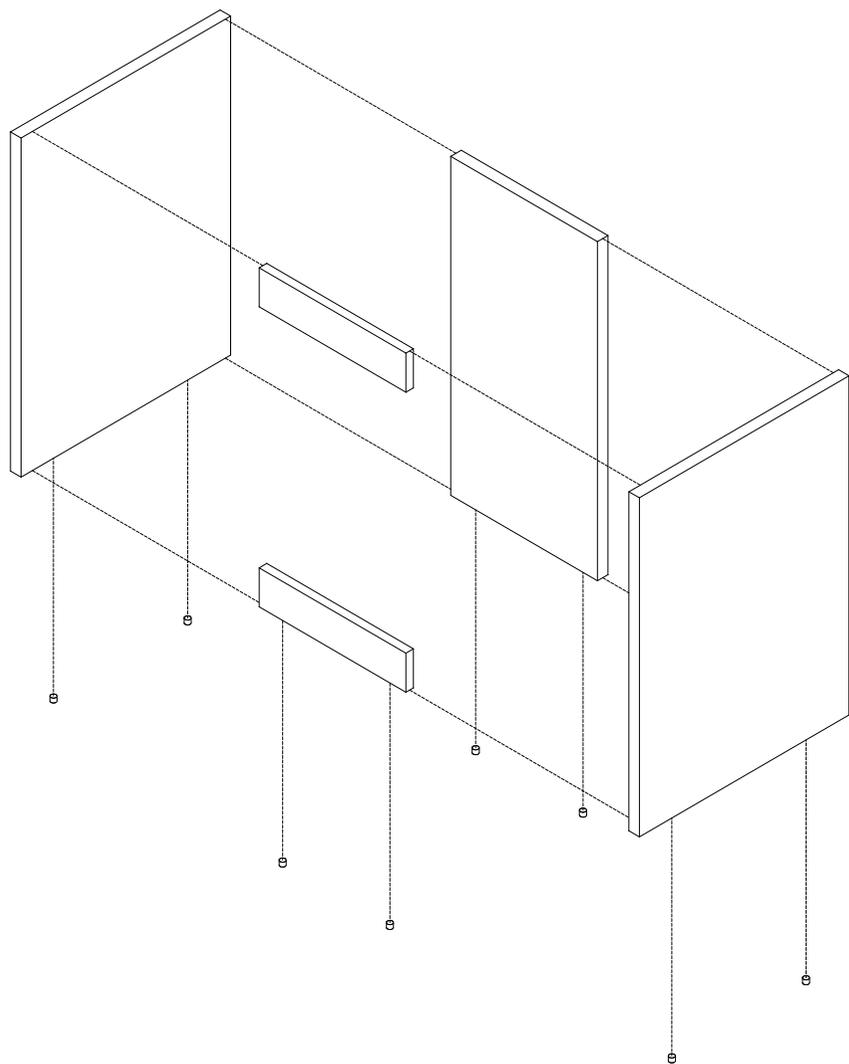
**1. Montare i due mobili sottopiano con tiranti, barilotti e spine; fissare i piedini nei fianchi, nel retro e nella fascia inferiore**
