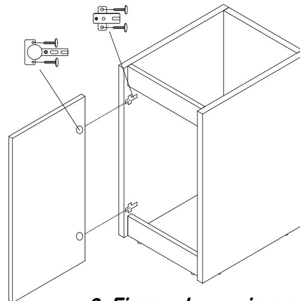
**2. Fissare le cerniere sull'anta, e l'anta alle basette del mobile ( da montare sul fianco )**
